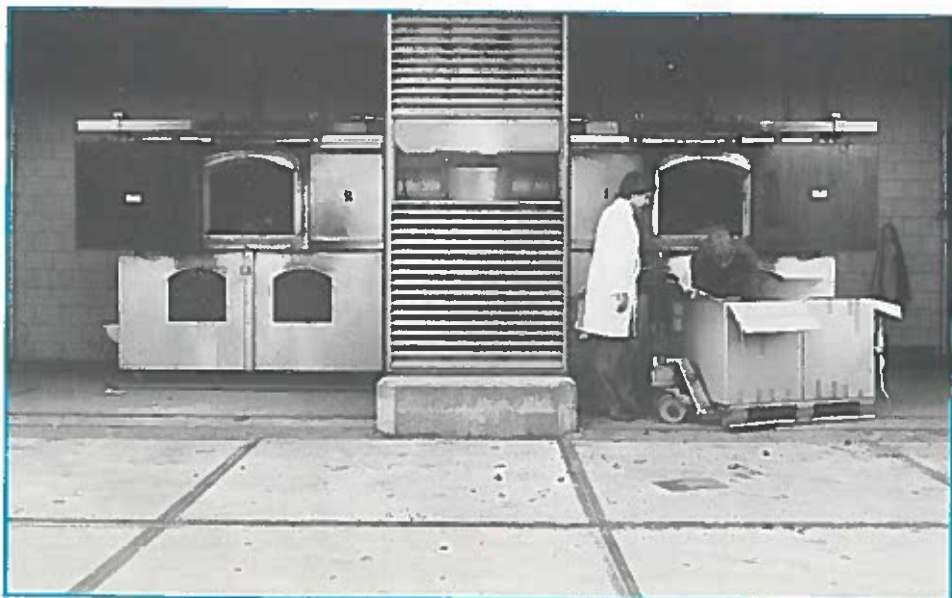
M. WIELAND regarde le chargement d'un four de brûlage des déchets provenant de l'industrie photographique.
